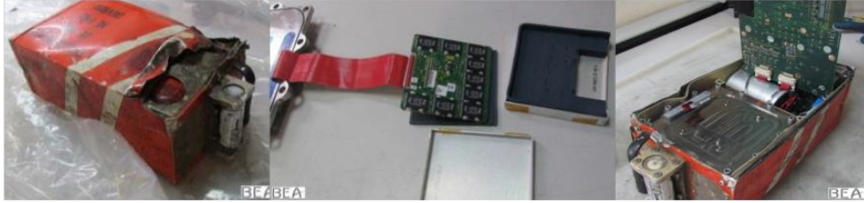
FCSSSU açılmış ve metal muhafaza kayıt cihazından ayrılmıştır.
