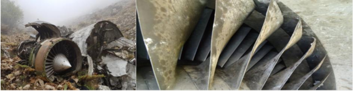
Solda 2 numaralı motor ve sağda 1 numaralı motora ait kompresör bölmesi
