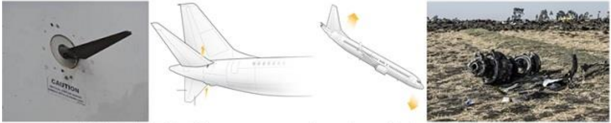
En solda hatalı girdi sağlayan sensör, ortada uçağın tepkisi ve en sağda felaket sonu
