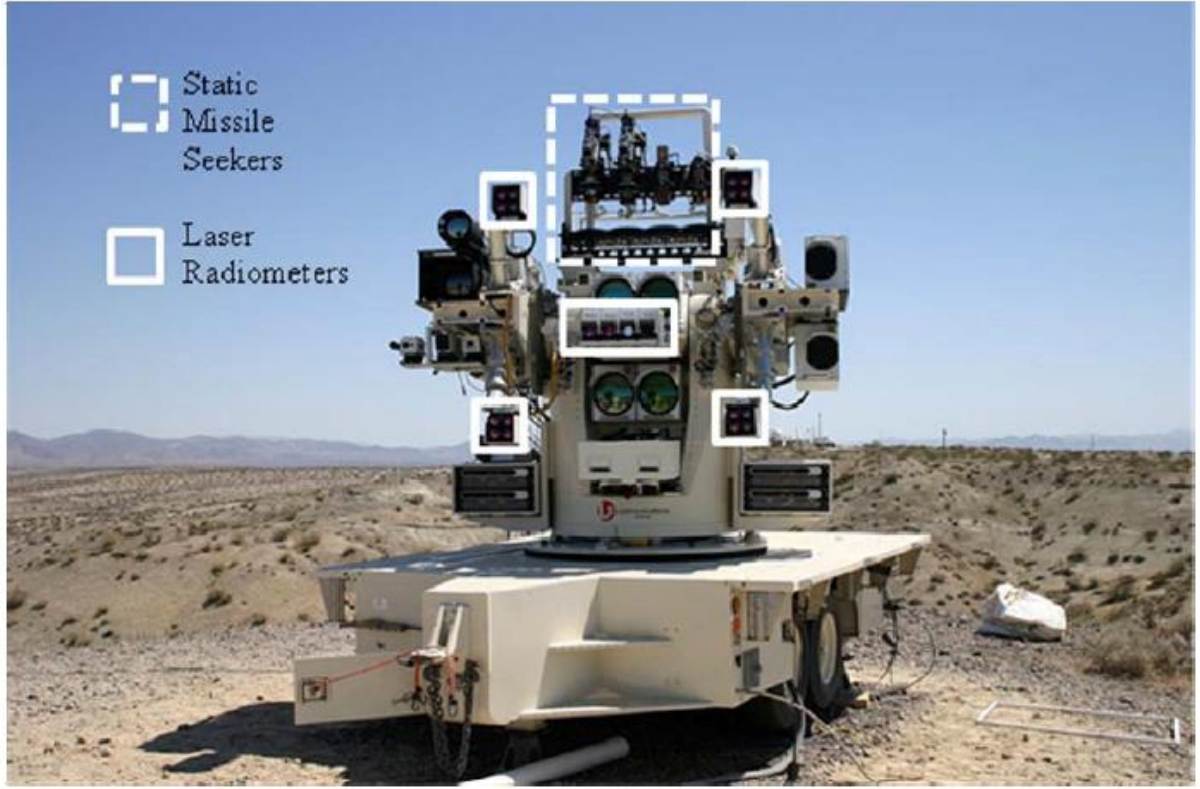
Şekil -8 IRCM Test Sistemi
