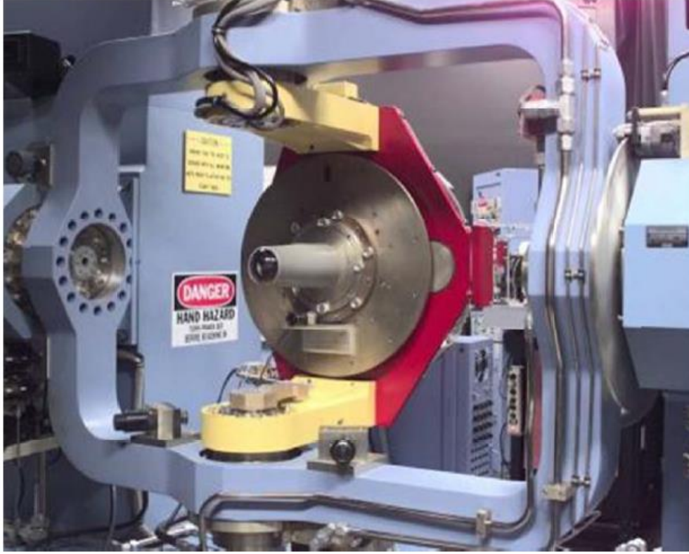
Şekil -7 Tam Hareketli Simülatöre Yerleştirilen IR Füze Arayıcı Başlığı
